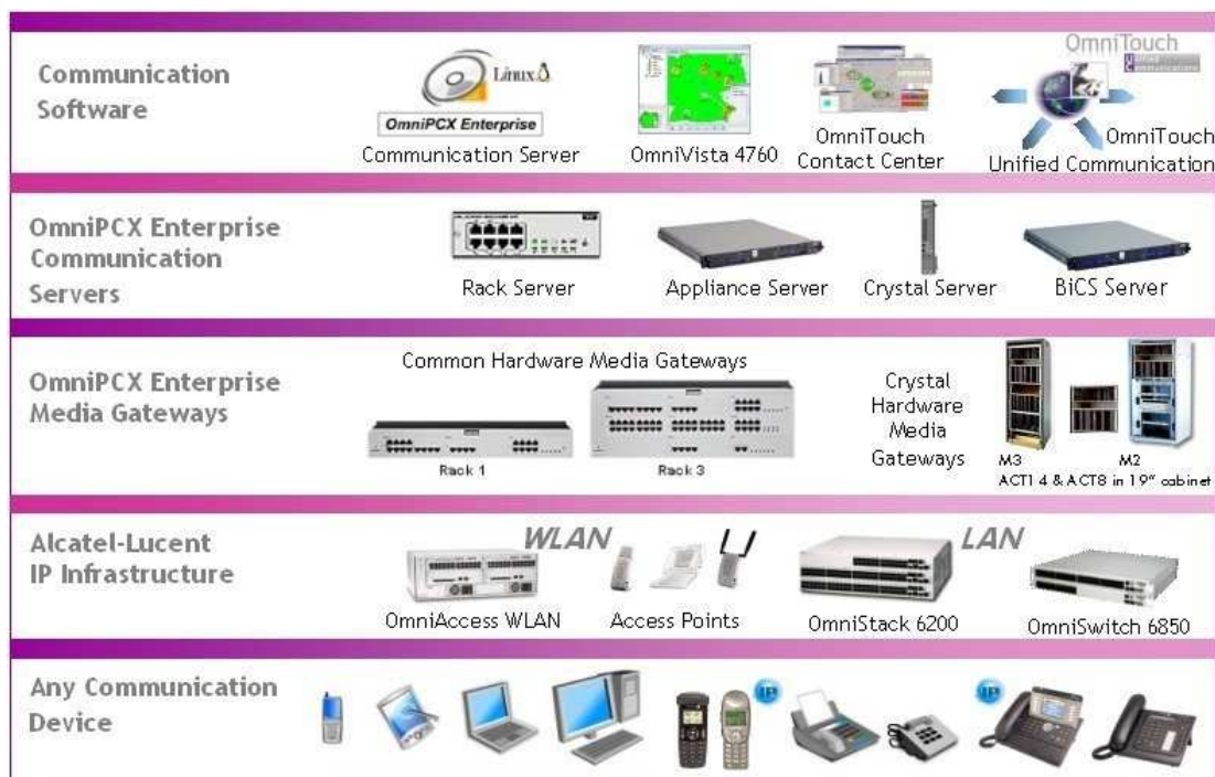
Obr. 7 Architektura komunikačního řešení Alcatel-Lucent OmniPCX Enterprise [35]
